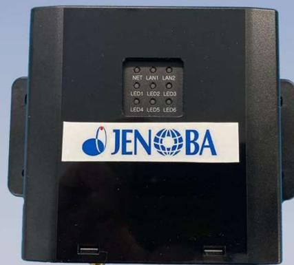
専用通信装置「CPTrans」は建機、農機、IoT機器など産業機器をKDDIの閉域網を使用して（CPA方式）、ジェノバセンターにネットワーク接続する機器です。
